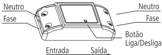
Certifique-se que a energia esteja desligada antes de começar a instalação e de que o local de instalação possua sinal Wi-Fi.
